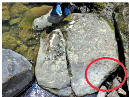
図18 No.2のそばにあったNo.3の岩。 側面にも楔で割った跡がある(赤丸内)
