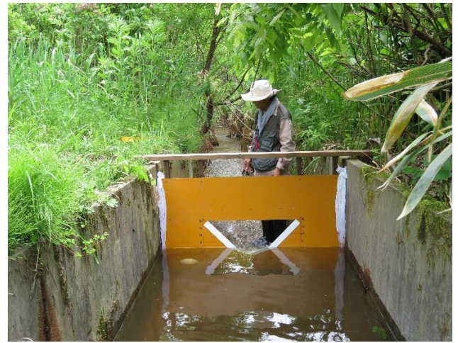
図-11 三角堰による水量観測(2018.6.5)
