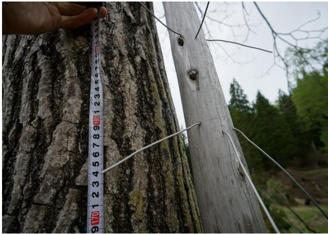
図-33 最大積雪量の計測結果（前季の報告書より抜粋、再掲）
